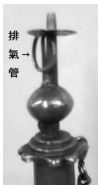
圖23.加上排氣管的戥管
