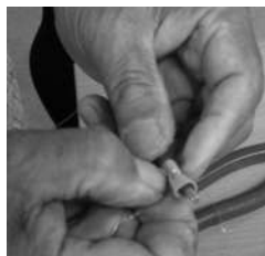
圖12.以銅線纏繞基座部位
