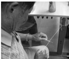
圖11.以棉線纏繞莖秆來回移動
