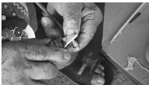
圖26：置入簧片並裁切木條固定住
